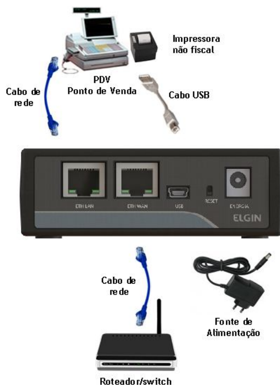
Figura 25 - MFE instalado fisicamente com todos os cabos
